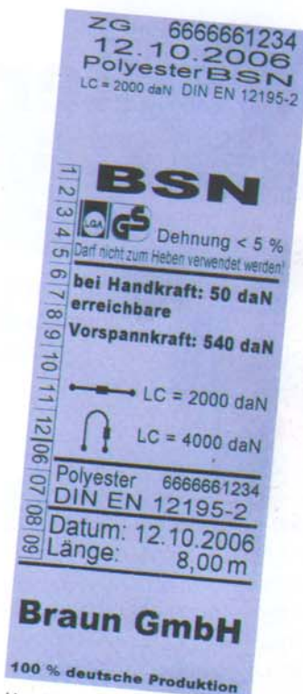
Man kommt ins Grübeln: Sieht so das Etikett eines „abgelaufenen Zurrgurts“ aus?
